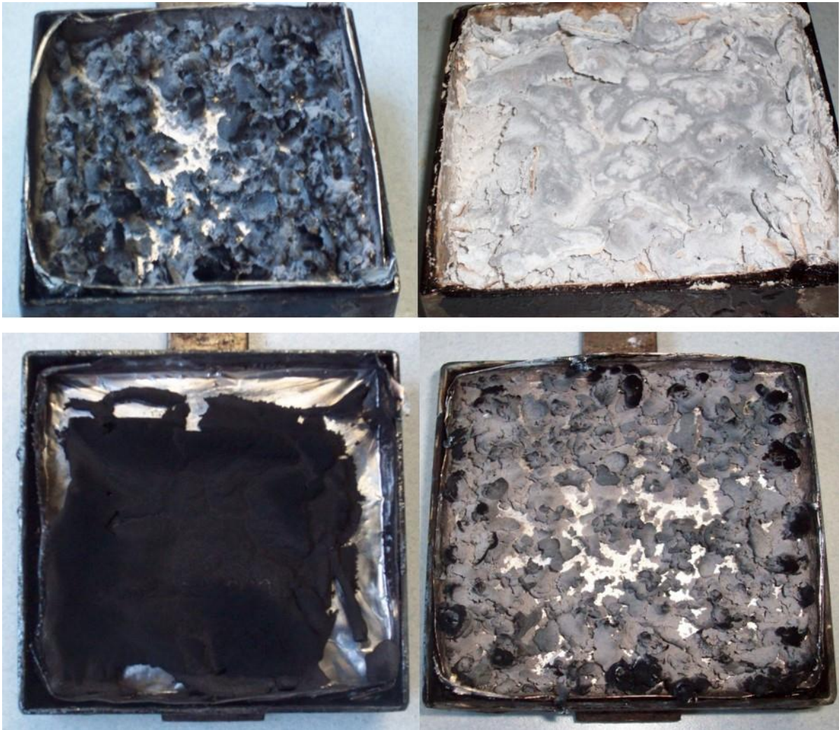
Alcuni residui di combustione dei materiali compositi dopo le prove al cono calorimetrico con evidente formazione di char.
